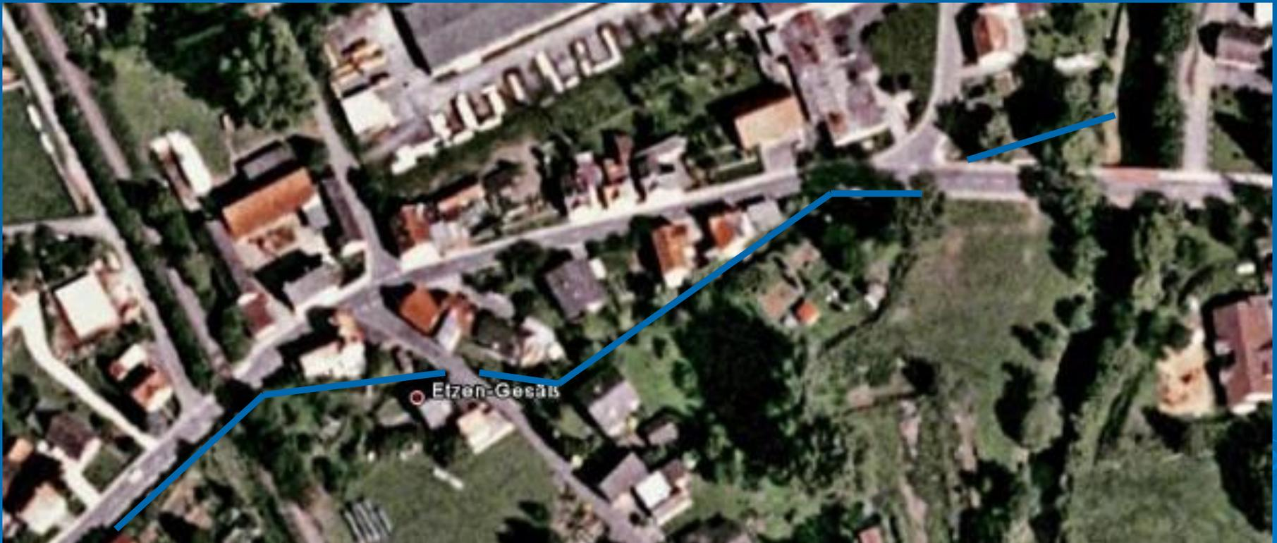
Die Ortslage Etzen-Gesäß ist für verschiedene Fischarten nicht passierbar. Die Ufer befinden sich zum Teil in einem naturfernen Zustand, das Abflussprofil ist zum Teil verengt.
